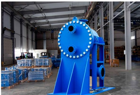
Кожухопластинчатый теплообменник - это теплообменное оборудование, конструктивно представляющее идеальное сочетание кожухотрубных и пластинчатых теплообменных аппаратов; объединяя в себе лучшие достоинства обоих: эффективность пластинчатого и безопасность кожухотрубчатого.
